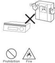
При установке прибора, во время работы которого вырабатывается тепло, желательно оставлять расстояние до стен сантиметров 5-10.
